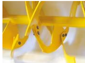
Austauschbares Löffelrührwerk (geringe Wartungskosten)
