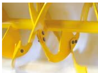
Austauschbares Löffelrührwerk (geringe Wartungskosten)
