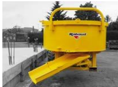
Schütte mit einklappbarer Verlängerung Entleeren über die Begrenzungslinie des Trägerfahrzeugs hinaus
