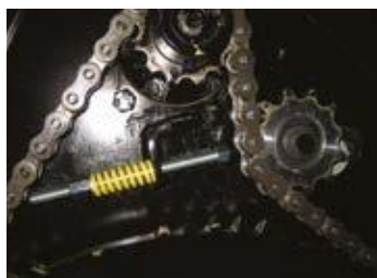
Großes Antriebsgetriebe (kein Ölbad-Getriebe, keine Wartung) mit Kettenspanner (außer TURBOMIX 117 und 230 GB)
