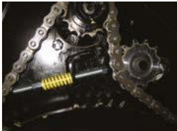
Großes Antriebsgetriebe (kein Ölbad-Getriebe, keine Wartung) mit Kettenspanner
