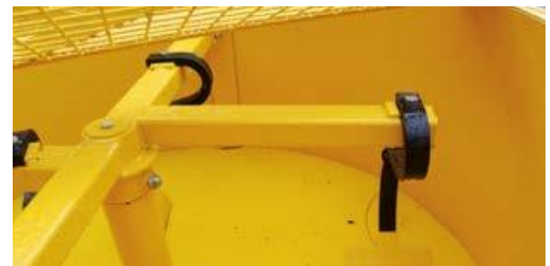
4 einstellbare Flügelblätter + 1 vertikale Schürfplatte
