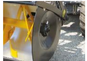
Lager im Seitenflansch integriert
