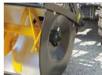
Lager im Seitenflansch integriert
