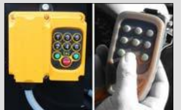
Funksteuerung für die Seitenöffnung 30 m Reichweite
