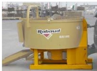
Rührschüssel auf verstärktem Rahmen, um die Stabilität des Ganzen zu erhöhen
