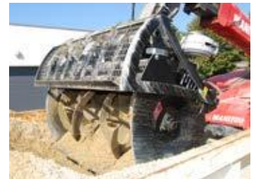
Gewölbtes Gitter für eine bessere Sicht. Öffnen des Gitters vom Fahrerplatz aus
