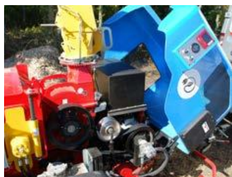
Polyesterhaube für einfachen Zugang zu den Maschinenkomponenten
