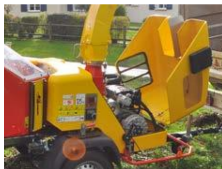
Polyesterhaube für einfachen Zugang zu den Maschinenkomponenten
