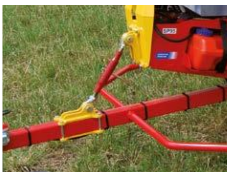
Einstellung des Häckslers zum Rahmen, je nach Anhängelhöhe
