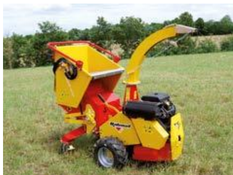
Bei der Lagerung klappbarer Trichter für eine ultrakompakte Maschine
