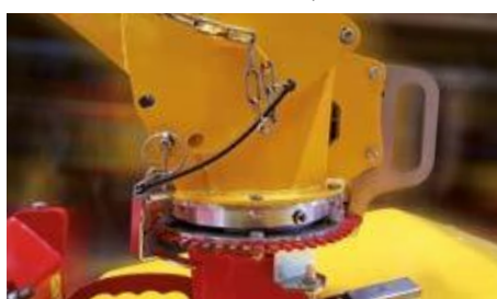
Auswurfrohr auf Kugelkranz montiert - drehbar um 360° + Sicherheitssensor für den Einzugsbereich
