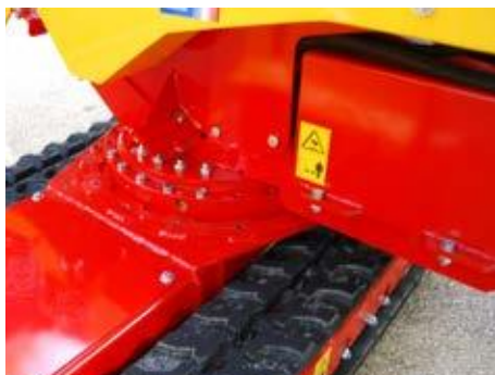
Häcksler um 180° drehbar
