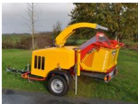
Klappbarer Trichter für mehr Kompaktheit beim Transport
