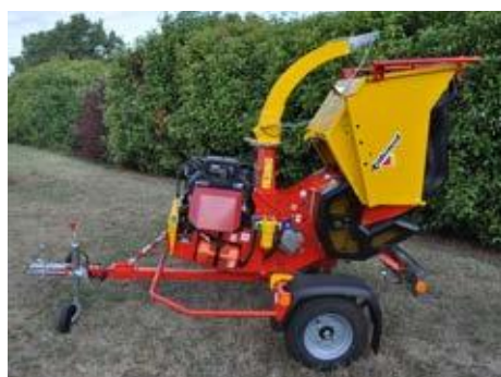
Klappbarer Trichter für den Transport
