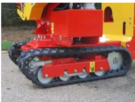
Raupenfahrwerk mit Spannvorrichtung
