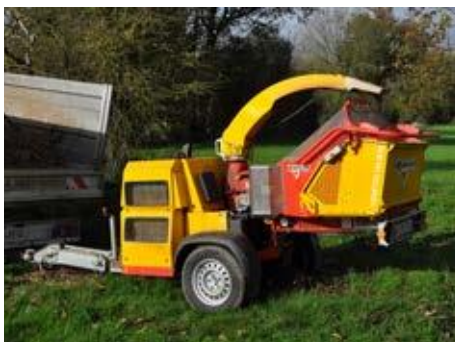
Klappbarer Trichter für den Transport
