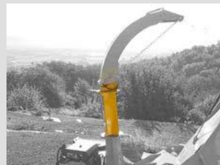
Erhöhtes Auswurfrohr 400 mm
