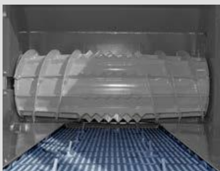
Einzugsband mit Mitnehmer Krallen zum besseren Greifen der Äste
