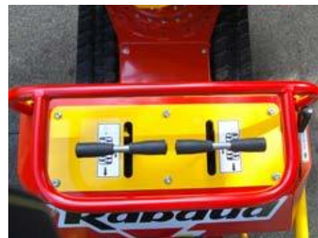
Bedienelemente vom Typ "Minibagger" für totale Ergonomie
