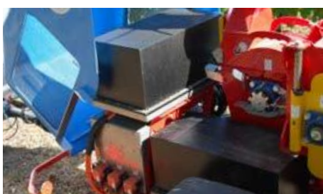
48-V-Batterie-Pack, keine elektrische Befähigung erforderlich.
