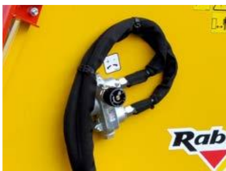
Einstellrad der Geschwindigkeit der Einzugswalze
