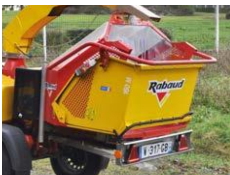
Klappbarer Trichter für den Transport
