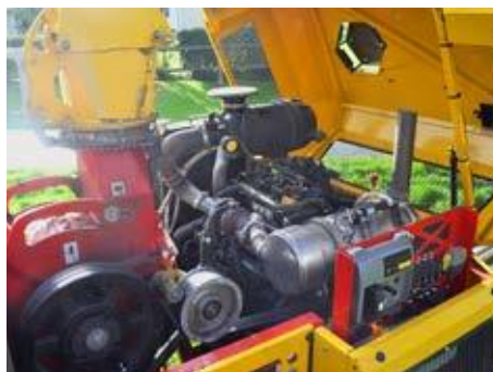
Polyesterhaube für einfachen Zugang zu den Maschinenkomponenten
