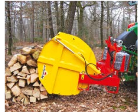
FAGOMATIC BU PRO mit Option hydraulische Seilspannung Kippzylinder längs der Maschine positioniert
