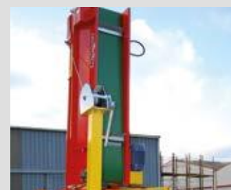
Abfuhrband für XYLOSCIE 700: 2 Modelle: Länge 4 oder 5 Meter
