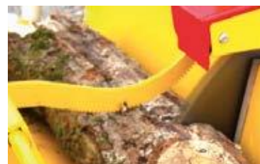
Stammklemme drückt das Holz so nah wie möglich an die Säge
