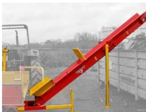
Zweihand-Steuerung mit mechanische Stammklemme (für ergonomisches und sicheres Arbeiten)
