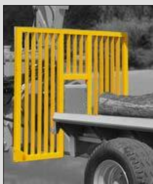
Schutzgitter für den Spaltzylinder und vom Bedienplatz
