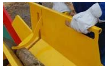
Zweihand-Steuerung mit mechanische Stammklemme (für ergonomisches und sicheres Arbeiten)
