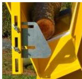
Einstellbare Schnittlänge über Kontrollstab
