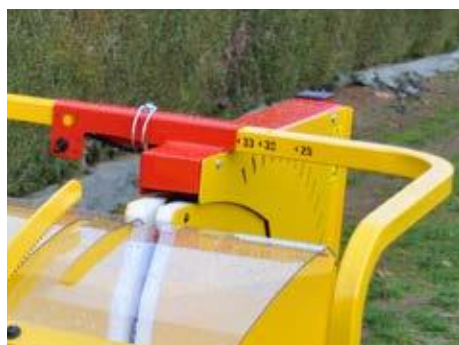
Einstellbare Schnittlänge über Kontrollstab
