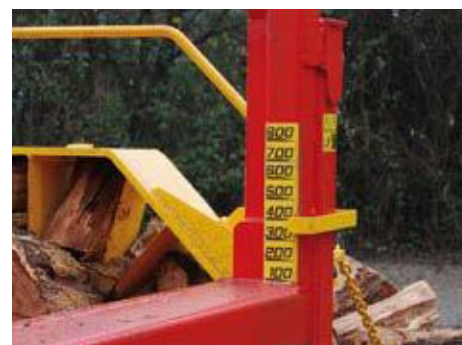
Hydraulische Spaltkreuz-Einstellung je nach Durchmesser des Stammes
