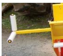
Stützrolle für Holzstämmen auf XYLOSCIE 700 mit Förderband von 4,80 m
