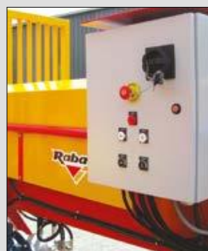
Elektroantrieb Drehstrommotor 22 kW / 30 PS Minimum 45 A Absicherung
