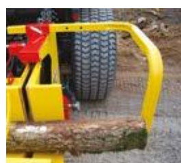
Einstellbare Schnittlänge über Kontrollstab auf XYLOSCIE 700
