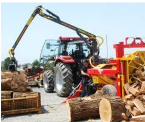
Forstkran mit 4,60 m, 6,75 m oder 8 m Länge auf dem Spalter montiert
