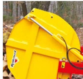
Hydraulische Entleerung des Bündels vom Bedienerplatz aus
