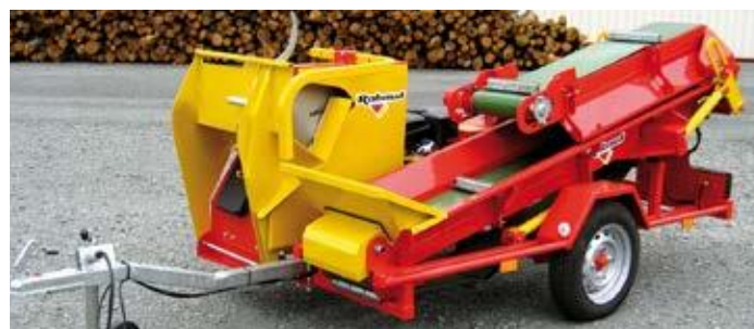
XYLOSCIE 700 M PRO + FÖRDERBAND 4,80 M Hydraulisch zusammengeklapptes Förderband, für den Transport
