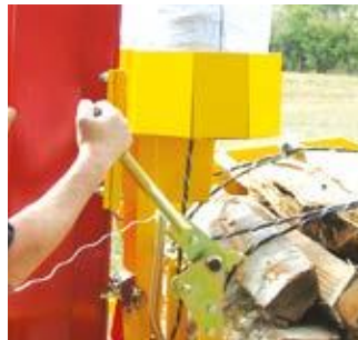
Mechanische Seilspannung durch Ratsche
