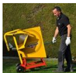
Transport durch 2 Vollgummiräder + Griff auf XYLOSCIE 600
