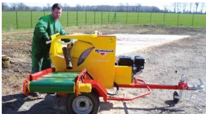
XYLOSCIE 700 M PRO + FÖRDERBAND 1,30 M Auswurfhöhe : 800 mm. Bandbreite : 450 mm
