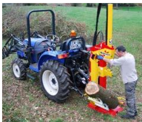
Stammheber als Standardausführung über Kettenanzug
