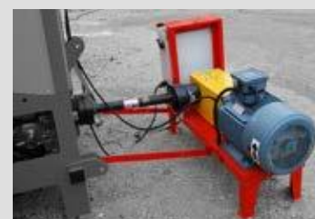
Elektroaggregat 18,5 kW / 25 PS oder Benzinmotor über POWER PACK
