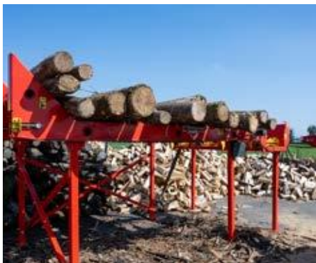
Option Ladetisch mit Ketten, 3 oder 5 Meter
