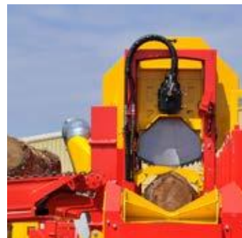
HM bestückte Kreissäge Ø 1300 mm, Schnittdurchmesser 520 mm
