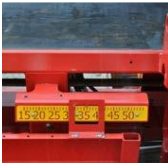
Schnittlängeinstellung von 200 bis 500 mm
