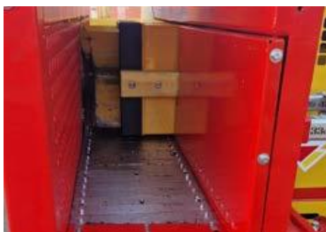
Einzugskanal von 15 bis 33 cm
