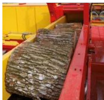
Pufferband zwischen Sägeeinheit und Spalter
