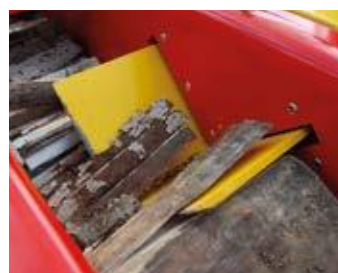
Spalkkraft von 5 Tonnen
