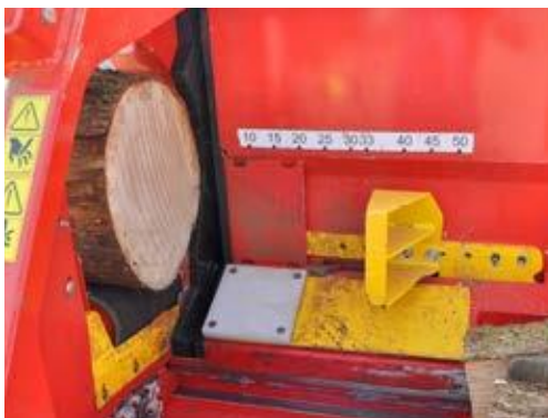
Anschlag für Schnittlängeneinstellung 200, 250, 300, 330, 350, 400, 450 oder 500 mm
