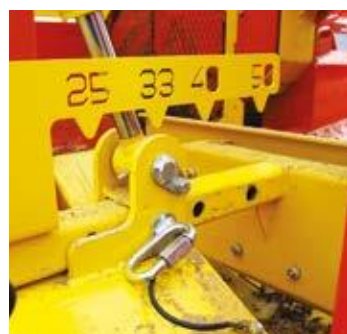
Schnittlängeneinstellung von 200 bis 500 mm
