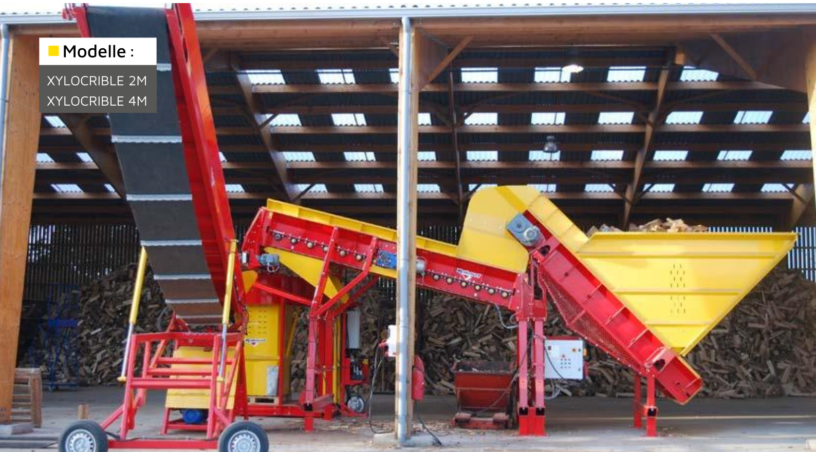
XYLOCRIBLE 4M mit geneigtes Zuführband mit Pufferspeicher
