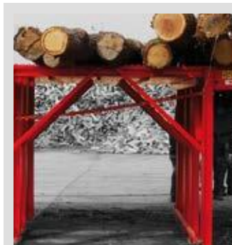
Holzzuführung über Ketten Querförderer : 2 m für Mobile Maschine, 5 bis 8 m für stationäre Maschine
