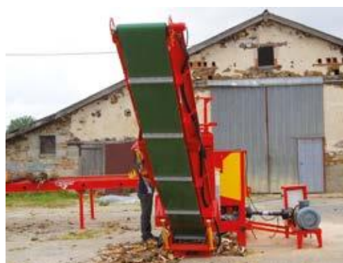
Scheitholzförderband mit Metallstollen (mehrfach für eine optimierte Wartung). Band über Hydraulikmotor gezogen.
