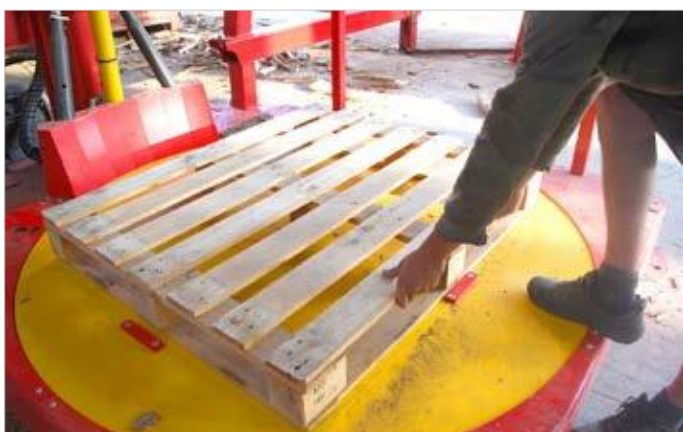
Einsetzen der Palette auf den Drehteller
