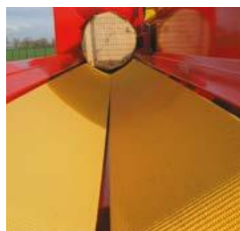
Einzugband mit „V“-förmigem Band (120°), Länge 4 m
