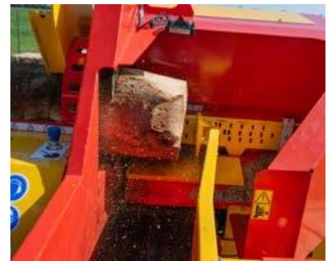
Schnittsystem über HM-Sägeblatt
