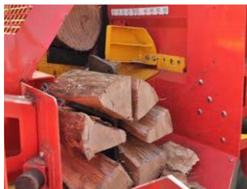
Hydraulisch höheneinstellbarer Spalkkreuz
