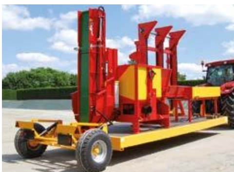
Auf absenkbarer Plattenwagen + 3 m Kettenquerförderer
