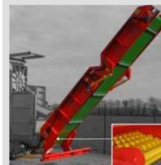
Scheitholz-Förderband von 4 Meter mit Metallstollen, hydraulische Höhenverstellung und hydraulisch schwenkbar
