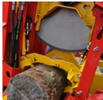
Doppelte Stammklemme zum Halten des Stammes (Zentrieren + Halten)
