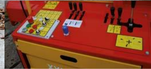
Steuerung aller elektrohydraulischen Funktionen über Bedienpult mit Spaltvorgang automatisch oder manuell
