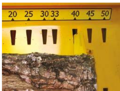
Einstellbare Schnittlänge von 150 mm bis 500 mm über Kontrollstab.
