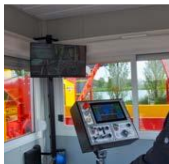
Bedienplatz mit Komfortsitz, Kameras für die Überwachung + Joystick-Steuerung Panoramablick auf die gesamte Einrichtung
