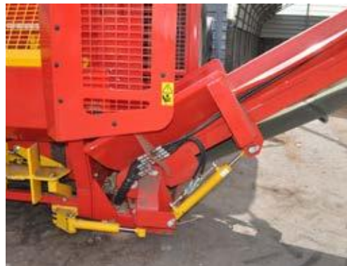
Förderband höheneinstellbar und hydraulischer Orientierung für TH Version
