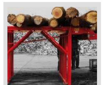
Holzzuführung über Ketten Querförderer : 2 bis 8 m für stationäre Maschine
