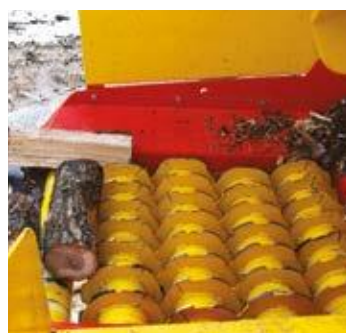
Sternsiebeinheit zum Sortieren des Abfalls vor dem Laden
