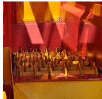
Sternsieveinheit am Spalterausgang
