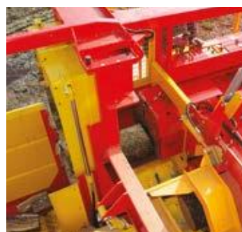
35-Tonnen-Schubzylinder mit automatischer, stufenloser Geschwindigkeitsregelung ISO POWER. Schubfläche von Ø 600 mm
