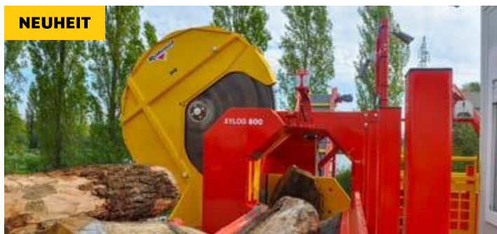
Erhältlich als Kreissägeblatt Ø 1,83 m - Dicke 7 mm - 80 Zähne Hartmetall
