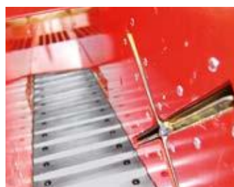
Einzugsband in Stahl und Spalkkreuz
