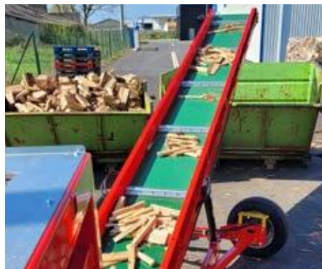
Option Förderband von 4, 5 oder 6 m mit hydraulischer Orientierung und Höheinstellung
