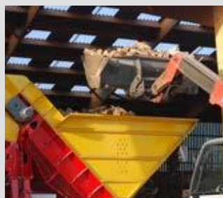
Geneigtes Zuführband mit Pufferspeicher
