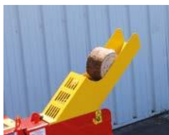
Einzugskanal Länge 1,50 m
