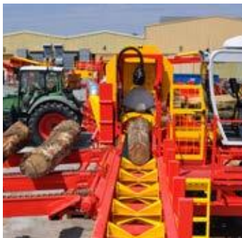
Gemischtes Zuführband für eine bessere Zentrierung des Stammes
