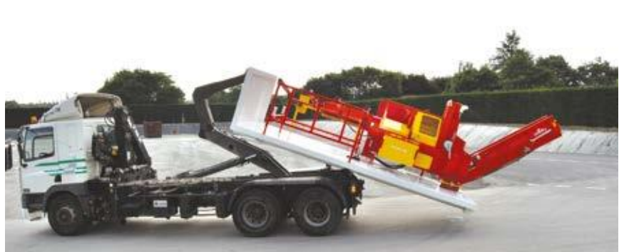
Plattform für Hackenlift + Kettenquerförderer Standard
