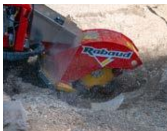
Bodenbearbeitung bis zu 200 mm unterhalb der Erdoberfläche
