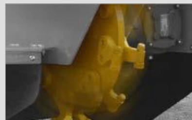
QuickStop (Hydraulische Bremse der Frässscheibe)
