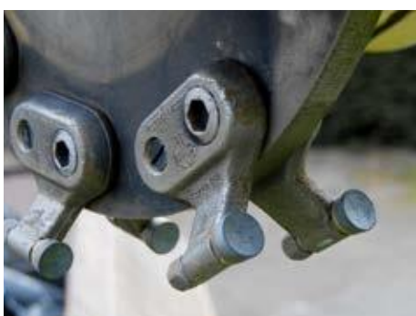
Fräszähne 3 max drehbar für 3 fache Lebensdauer
