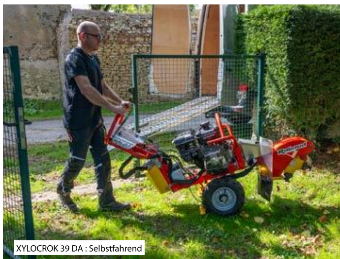
Bodenbearbeitung bis zu 200 mm unterhalb der Erdoberfläche
