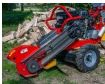
Bodenbearbeitung bis zu 200 mm unterhalb der Erdoberfläche
