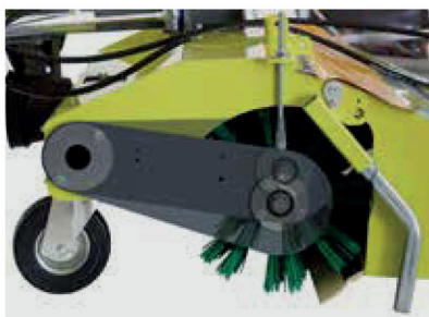
Spazzolone flottante per adeguarsi al suolo Oscillating swivel brush to follow ground contours Schwenkbare Bürste Brosse flottante pour s'adapter au sol
